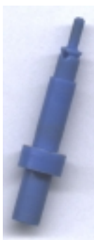
Slika 1: «Samsung test-ključ» za namještanje «kalibracijskog koda»
